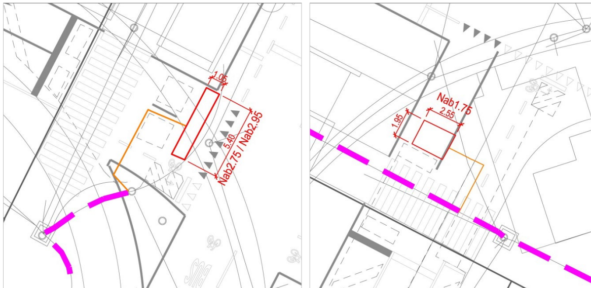
Bild 37: Abmessungen NF-Abmeldeschleife
